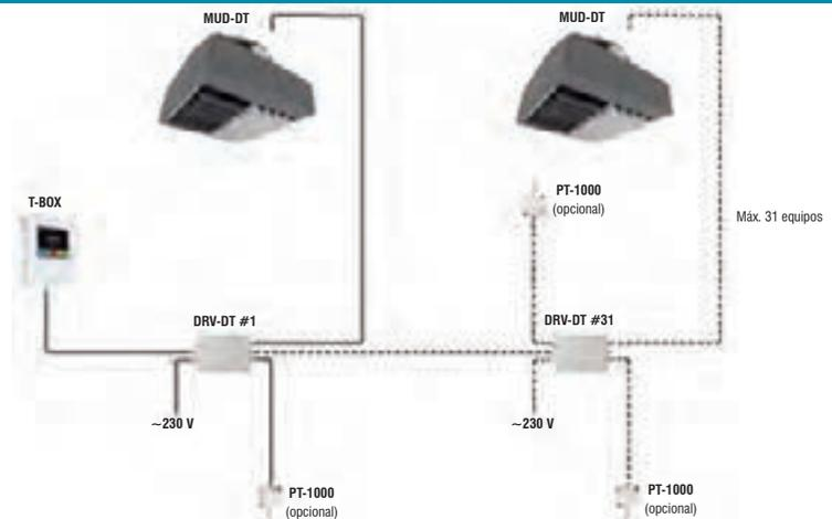
2.- CONEXIÓN DEL CONTROL CENTRALIZADO T-BOX + MÓDULO DRV-FB + SENSOR PT-1000 + AEROTERMO MUAT-FB + MÓDULO DRV-DT + DESESTRATIFICADOR MUD-DT
