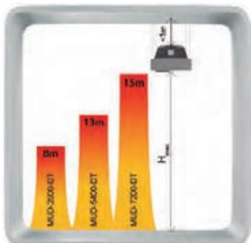
H<sub>max</sub> - Altura máxima instalando los deflectores verticalmente
