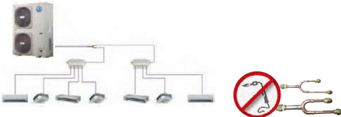
Las conexiones abocardadas tanto de la caja como de los colectores son de 3/8"-5/8" en el lado de la unidad exterior y de 1/4"-1/2" en el lado de la unidad interior.
