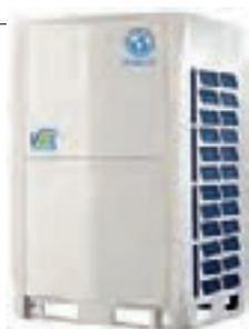
Sistemas de caudal variable de refrigerante a 2 tubos modulares de las que se pueden combinar hasta un máximo de 3 unidades exteriores, tecnología Super DC Inverter, con un o dos compresores Scroll según el modelo, conectividad de hasta 64 unidades interiores o el 130% de capacidad de la exterior.
