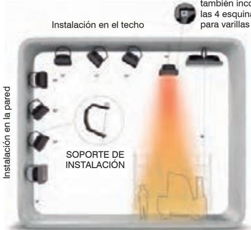
Los aerotermos MUAT-FB también incorporan en las 4 esquinas sujeciones para varillas roscadas.
