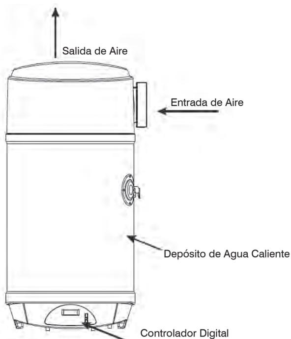
Salida roscada para conexión de desagüe de condensados y entrada /salida de agua en acero inox. Entrada de aire conexión de Ø150mm. Salida de aire conexión de Ø125mm.
