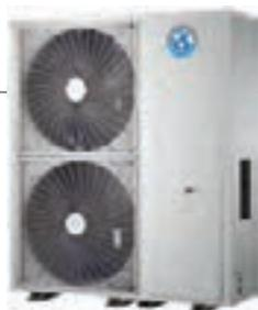
Unidades de caudal variable de refrigerante individuales a 2 tubos, con unidad exterior de descarga de aire frontal, tecnología Super DC Inverter, modelos de 40 y 45 kW incorporan dos compresores que aseguran la estabilidad del sistema, conectividad de hasta 15 unidades interiores o el 130% de capacidad de la exterior.
