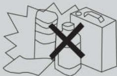
4. Ne pas éclabousser d'eau à l'intérieur de l'appareil car il y a des micro-ordinateurs et des plaques sur l'appareil qui ne peuvent pas entrer en contact avec l'eau.
