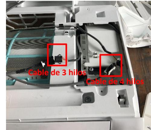
El cable de 3 hilos conecta el Módulo Multifunción y el "display" receptor
