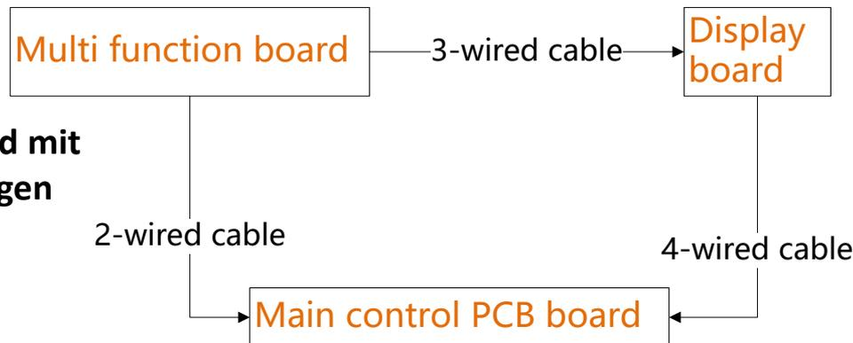
Das 2-adrige Kabel wird mit einem weiteren 2-adrigen Kabel zwischen der Hauptplatine der Inneneinheit und dem Multifunktionsmodul verbunden.
