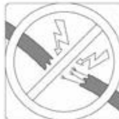
Prüfen Sie auf beschädigte Kabel
