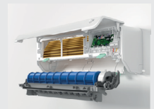
Abra os encaixes traseiros e retire todo o sistema de ventilação, incluindo o tabuleiro de condensados
