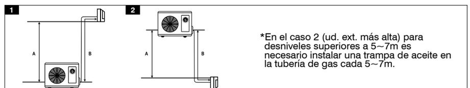
\*En el caso 2 (ud. ext. más alta) para desniveles superiores a 5~7m es necesario instalar una trampa de aceite en la tubería de gas cada 5~7m.
