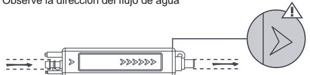
7. Empuje el tubo de 9 mm o/d x 6 mm i/d en el depósito y en la bomba. Asegure con las bridas. Asegúrese de que la longitud sea inferior a 2 metros.
