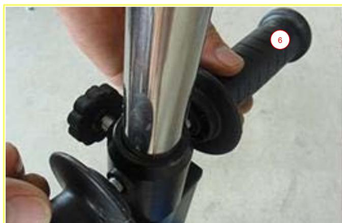
8. Monte el motor del ventilador en la unión del polo y apriete el perno y el tornillo pequeño.
