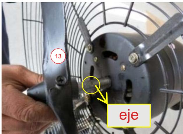
11. Instale con tornillos la protección delantera en el generador de niebla.
