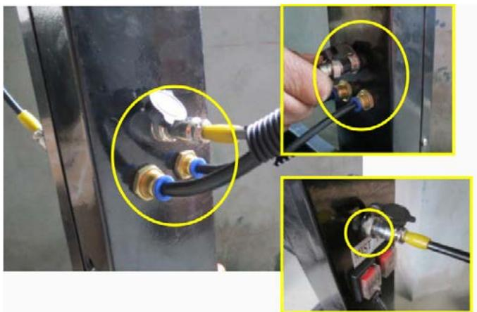
14. Pase el tubo de entrada y el enchufe eléctrico de la bomba por el agujero del depósito, y luego conectar en la conexión del poste. Pase el tubo de drenaje al depósito de agua como en la imagen inferior
