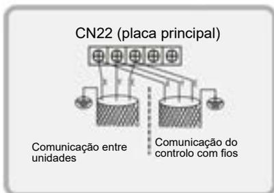
Tal como mostrado na figura a seguir, para MUENR-90-H12T / MUENR-90 -H12T(K) e MUENR-180- H12T / MUENR-180-H12T(K): O cabo de sinal de comunicação da unidade está ligado ao bloco de terminais XT2 a 5(X), 6(Y) e 7(E), e o cabo de sinal do controle com fios está ligado a 8(X), 9(Y) e 10(E) dentro da caixa de controle elétrico. Para a cablagem específica, consulte o capítulo 8.4.14.
