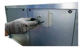
Para levantar el panel: Desatornillar el retenedor
