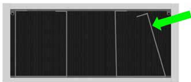
Fig. 28.1 GR retirando el clip de retención de la espuma de entrada
