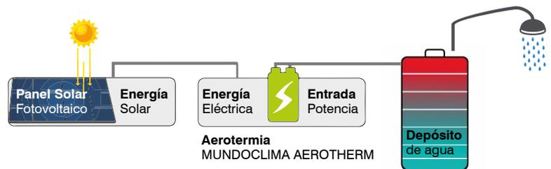
2. Tengo producción fotovoltaica, pero **no** tengo demanda en la **Aerotherm**. De manera automática el sistema aumentará la temperatura del agua caliente sanitaria acumulada, creando una batería de calor (energía de reserva en forma de calor).
