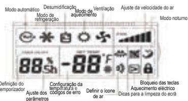
Fig.2 Visor LCD do controlo com fio
