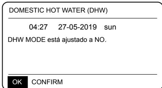
2. Si DISINFECT MODE=NON en FOR SERVICEMAN, elija **MENÚ > DOMESTIC HOT WATER > DOMESTIC HOT WATER**. Pulse **OK**. Se visualiza lo siguiente: DOMESTIC HOT WATER (DHW)
