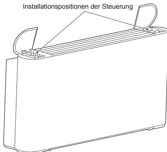
Abb. 3-1 Installationspositionen der Steuerung
