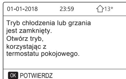
② Jeśli w menu termostatu pokojowego ustawiono pozycję **USTAW STREFĘ PODWÓJNĄ** (patrz sekcja „**KONFIGURACJA TERMOSTATU POKOJOWEGO**” w instrukcji dotyczącej montażu i obsługi wewnętrznej jednostki dzielonej firmy **M-Thermal**), termostat pokojowy przypisany do cewki wentylatora zostanie wyłączony, termostat pokojowy ogrzewania podłogowego zostanie włączony, jednostka będzie działać, ale wyświetlacz pozostanie OFF. Wyświetlona zostanie poniższa strona:
