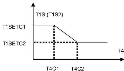
Stan: przy tej konfiguracji kontroler przewodowy. Jeśli  $T4C2 < T4C1$ , wtedy zmień wartość. Jeśli  $T1SETC1 < T1SETC2$ , wtedy zmień wartość.
