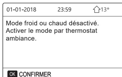
② Le thermostat d'ambiance est RÉGLÉ sur DOUBLE ZONE (voir « RÉGLAGE THERMOSTAT AMBI » dans « Manuel d'installation et d'utilisation (unité intérieure split M-Thermal) »). Le thermostat d'ambiance du ventilateur-convecteur est désactivé, le thermostat d'ambiance du chauffage au sol est activé et l'unité est en marche, mais l'affichage est OFF. La page suivante est affichée:
