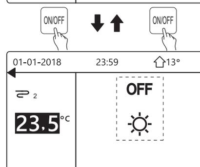
Korzystając z interfejsu, włącz lub wyłącz jednostkę DHW. Przcisnij klawisz „►”, „▼” na stronie głównej, a wyświetlony zostanie czarny kursor:
