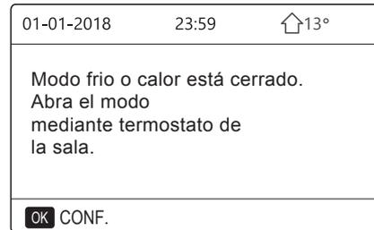
② El termostato de sala es AJUSTA ZONA DOBLE (consulta "AJUSTE TERMOSTATO SALA" en "Instalación y manual del propietario (Unidad interior split M-thermal)"). El termostato de sala para fancoil se apaga, el termostato de sala para la suelo radiante se enciende, y la unidad está funcionando, pero la pantalla es OFF. Se muestra la siguiente página:
