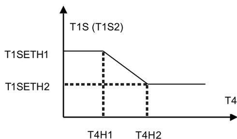
Stan: przy tej konfiguracji kontroler przewodowy. Jeśli  $T4H2 < T4H1$ , wtedy zmień wartość. Jeśli  $T1SETH1 < T1SETH2$ , wtedy zmień wartość.
