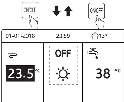
Korzystając z termostatu pokojowego, włącz lub wyłącz ogrzewanie lub chłodzenie przestrzeni przez jednostkę.
