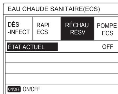
Utilisez « ON/OFF » pour sélectionner ON ou OFF. Utilisez « BACK » pour sortir.
