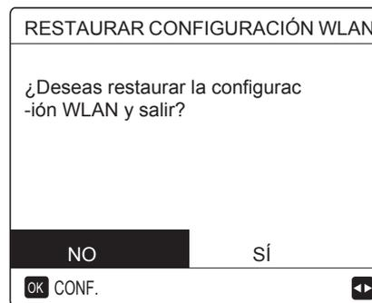
Usa "◀", "▶" para ir a "SÍ", pulsa "OK" para restablecer los ajustes WLAN. Completa la anterior operación y la configuración inalámbrica se restablece.
