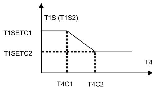
Estado: na definição do controlador com fios, se  $T4C2 < T4C1$ , substitua o respetivo valor. Se  $T1SETC1 < T1SETC2$ , substitua o respetivo valor.
