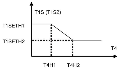
Estado: na definição do controlador com fios, se  $T4H2 < T4H1$ , substitua o respetivo valor. Se  $T1SETH1 < T1SETH2$ , substitua o respetivo valor.
