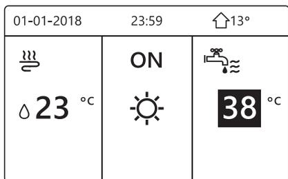
2) Gdy kursor znajduje się na temperaturze trybu DHW, przyciśnij klawisz „ON/OFF”, aby go włączyć lub wyłączyć.
