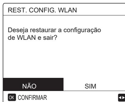
Utilize "◀", "▶" para mover para "SIM", pressione "OK" para restaurar a definição de WLAN. Conclua a operação acima e redefina a configuração sem fios.
