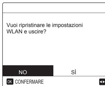
Utilizzare "◀" e "▶" per spostarsi su "Sì". Premere "OK" per ripristinare l'impostazione WLAN. Completare l'operazione precedente. A questo punto, la configurazione wireless è stata ripristinata.
