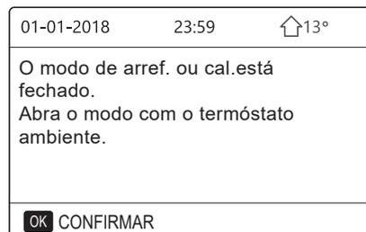
② O termóstato ambiente está definido como ZONA DUPLA (consulte “DEFINIR TERMÓSTATO AMBIENTE” em “Manual de instalação e do proprietário (unidade interior dividida M-thermal)”). O termóstato ambiente do ventilador-convetor é desligado, o termóstato ambiente é ligado e a unidade é ativada e a unidade está em funcionamento, mas o visor é desligado. A seguinte página é apresentada:
