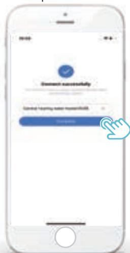
4) Quando o equipamento estabelecer ligação com sucesso, o ícone de LCD "Wi-Fi" do controlador com fios fica ligado de maneira permanente e o ar condicionado pode ser controlado através da aplicação.
