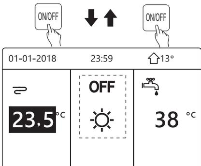
Utilizzare il termostato ambiente per attivare o disattivare il riscaldamento o il raffreddamento ambiente.
