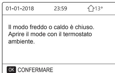
② Il termostato ambiente è impostato su DUE ZONE (vedere **"IMPOSTAZIONE TERMOSTATO AMBIENTE"** nel **"Manuale per l'utente e di installazione - Unità interna split M-Thermal"**). Il termostato ambiente per il ventilconvettore è disattivato, il termostato ambiente per il riscaldamento a pavimento è attivato e l'unità è in funzione, ma il display è spento. Viene visualizzata la pagina seguente:
