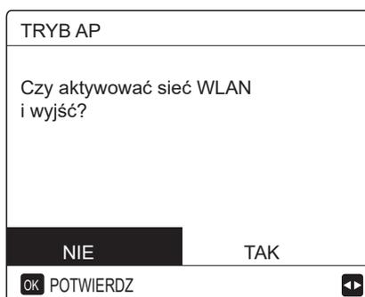
Klawiszami „◀” i „▶” wybierz pozycję „TAK” i przyciśnij klawisz „OK”, aby wybrać tryb AP. Wybierz tryb AP odpowiednio do urządzenia przenośnego i przechodź do kolejnych ustawień zgodnie z monitami APLIKACJI.
