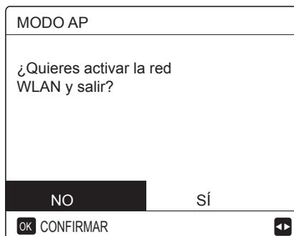
Usa "◀", "▶" para ir a "SÍ", pulsa "OK" para seleccionar el modo AP. Selecciona el Modo AP según el dispositivo móvil y continúa con los siguientes ajustes según las indicaciones de la APP.
