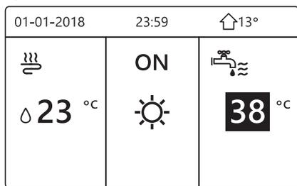
2) Cuando el cursor está en la temperatura del modo ACS. Pulsa la tecla "ON/OFF" para encender/apagar el modo ACS.
