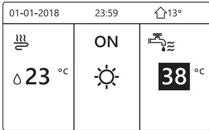
2) Quando o cursor está na temperatura do modo DHW. Pressione a tecla “Ligar/desligar” para ligar/desligar o modo DHW.
