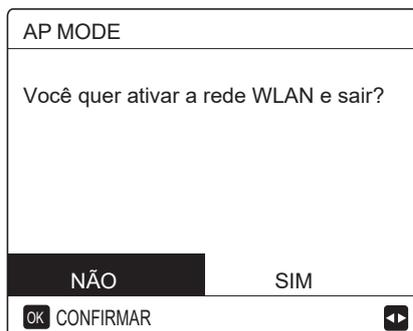
Utilize "◀", "▶" para mover para "SIM", pressione "OK" para selecionar o modo PA. Selecione o Modo PA no dispositivo móvel e efetue as definições de seguimento de acordo com os pedidos da aplicação.
