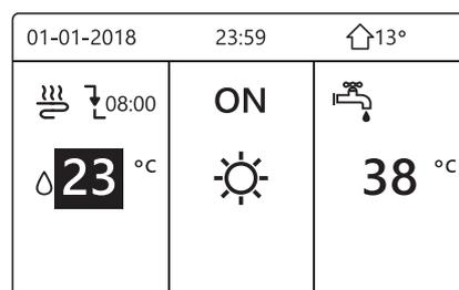
1) Gdy kursor znajduje się nad temperaturą strony trybu pracy w przestrzeni (obejmuje tryb grzania , tryb chłodzenia , tryb automatyczny , przyciśnij klawisz „ON/OFF”, aby włączyć/wyłączyć ogrzewanie lub chłodzenie przestrzeni.
