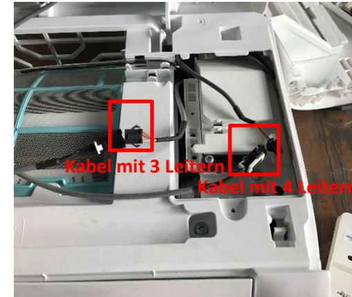
Das 3-adrige Kabel verbindet das Multifunktionsmodul und den Empfänger „Display“
