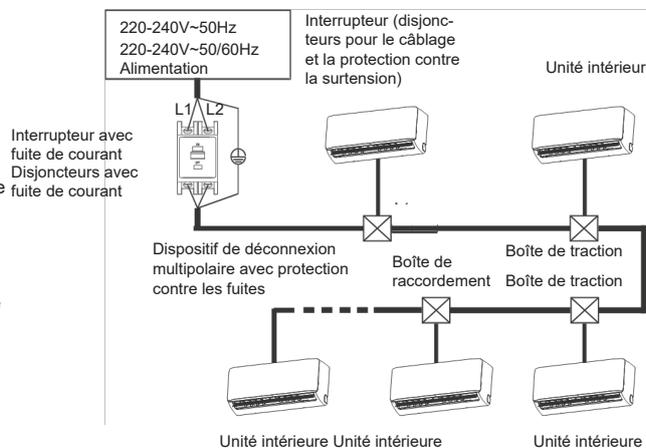
Se reporter aux tableaux 6.1 et 6.2 pour les spécifications des câbles d'alimentation et de communication. Une capacité de câblage trop faible peut provoquer une surchauffe du cordon d'alimentation et provoquer des accidents lorsque l'appareil est brûlé et endommagé.
