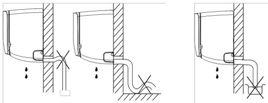
Aucune section de la conduite d'évacuation d'eau ne doit être dirigée vers le haut.
