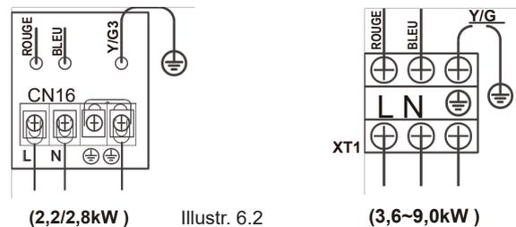
Lors du raccordement à la borne d'alimentation, utilisez la borne de câblage circulaires avec gaine isolante (voir Illustr. 6.3).
