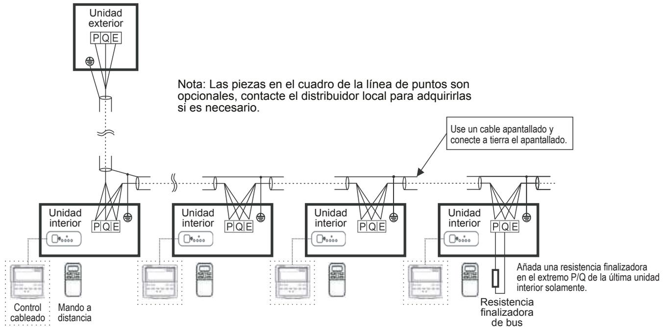
Cableado de comunicación entre la unidad exterior y las interiores
