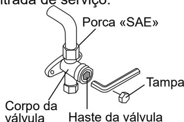
12. Com a chave Allen abra completamente as válvulas de alta e de baixa pressão.
