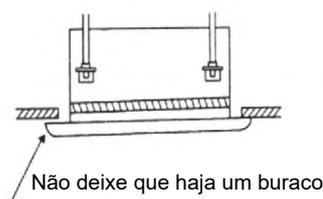
Se o nível da unidade interior e o tubo de drenagem não drenarem, não há problema em ajustar a altura da unidade interior através dos orifícios do painel decorativo.
