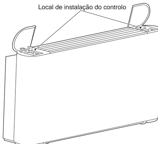
Figura 3-1 Posição de instalação do controlo
