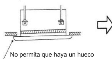
Si el nivel de la unidad interior y el tubo de desagüe no drenan, estará bien ajustar la altura de la unidad interior a través de los agujeros del panel decorativo.
