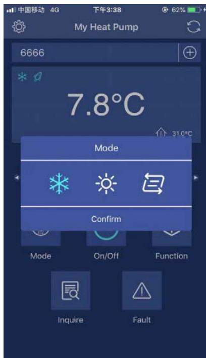
Después de ajustar el modo de funcionamiento, en el área de iconos del modo de funcionamiento se mostrará su selección en el lado izquierdo de la pantalla.
