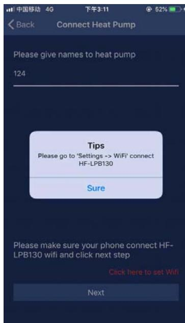
Für das Android-System geht die Schnittstelle direkt in das mobile WIFI-Konfigurationsmenü, um HF-LPB130 auszuwählen.
