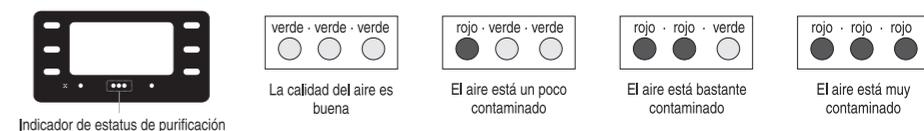
Cuando la calidad del aire es suficientemente buena, la unidad se apagará automáticamente. En caso contrario, arrancará automáticamente.
