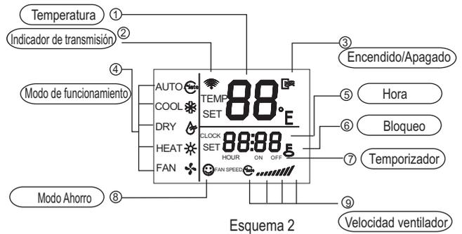
1-Temperatura: Muestra la temperatura programada. Ajuste la temperatura con los botones.
