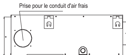
Prise pour le conduit d'air frais
