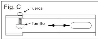
**Nota:** El tornillo y tuerca son utilizados para fijar de fijación de la ventana.
