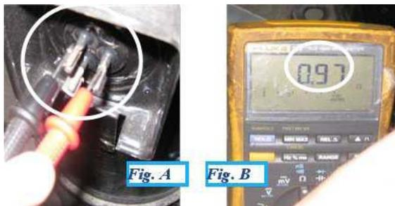
3.2 Mida la resistencia entre U, V y W del compresor y GND, respectivamente. La resistencia debería ser de más o menos los mismos mega-Ohms.
