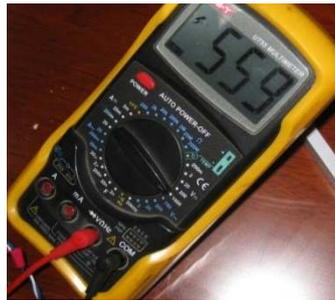
Paso 2: compruebe la tensión del condensador. El valor normal debe ser de 510 V  $\pm$ 30 V o 310 V  $\pm$ 30 V. Si no está en estos rangos es que el circuito impreso falla y hay que sustituirlo.
