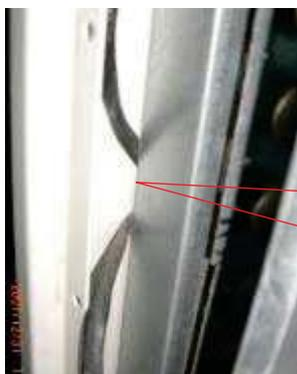
El sensor T4 está desgastado y conectado a una placa metálica
