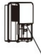
Abb.8 Bringen Sie den Pumpenschlauch richtig an.
