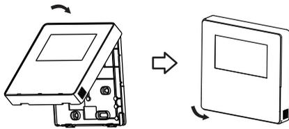
Instale correctamente el panel frontal y la placa trasera, de lo contrario puede provocar la caída del panel frontal (Fig. 6.2)
