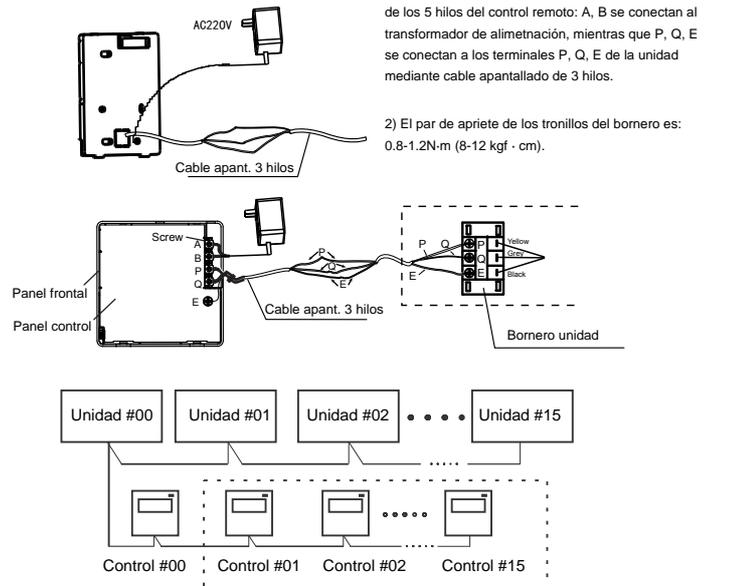
Usar los terminales PQE para conectar todos los controles en paralelo.
