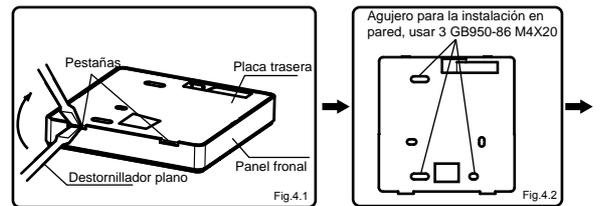
1) Usar un destornillador plano para desancorar las pestañas de la parte inferior del control cableado (poner atención al sentido de las pestañas, de lo contrario se dañará la placa trasera) (Fig. 4.1)
