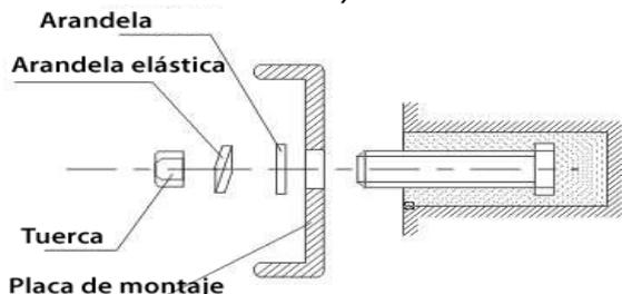
3.1.4 Instale el cuerpo principal. Ajuste el cuerpo principal desde el extremo superior de la placa de montaje y enganche la unidad como se muestra en la figura.
