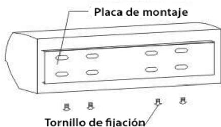
3.3.2 Soportes de fijación al techo como en la figura.
