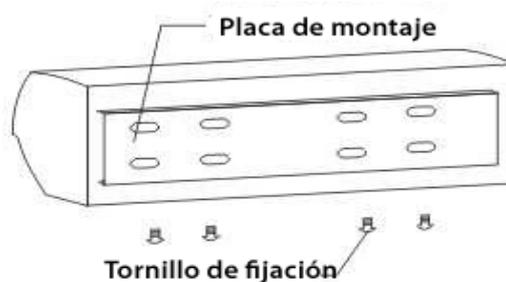
3.1.3 Cuando el cemento esté endurecido, instale la placa de montaje (use la abrazadera y la tuerca como se muestra a continuación)
