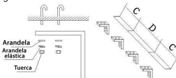
3.3.3 Ajuste la placa de montaje en los soportes para techo, asegure y fije bien (use los tornillos sujetos a los soportes para techo como en la figura) Si usa los soportes para techo para colgar la unidad del techo la posición de la placa de montaje se puede ajustar hasta 100 mm.
