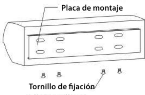
3.1.2 Fije los tornillos en la posición adecuada (Decida la posición con la placa de montaje y cubra los agujeros perforados con cemento).
