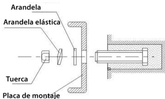
3.1.4 Instale el cuerpo principal. Ajuste el cuerpo principal desde el extremo superior de la placa de montaje y enganche la unidad como se muestra en la figura.
