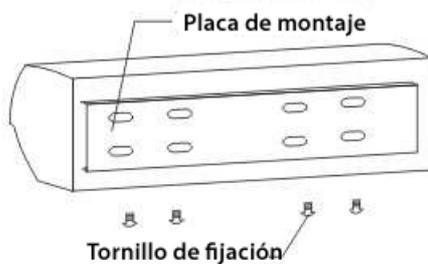
3.1.2 Fije los tornillos en la posición adecuada (Decida la posición con la placa de montaje y cubra los agujeros perforados con cemento).
