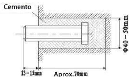
3.1.3 Cuando el cemento esté endurecido, instale la placa de montaje (use la abrazadera y la tuerca como se muestra a continuación)
