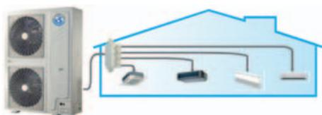
Nota: en las unidades exteriores de potencia inferior a 20 kW, en el momento que se conectan más de dos unidades la potencia máxima de cada interior no puede superar los 8 kW.
