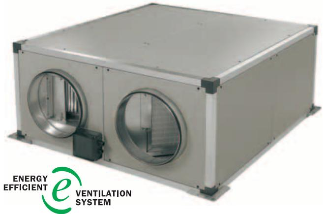
Recuperadores de calor, con intercambiador de flujos cruzados, montados en cajas de acero galvanizado plastificado de color blanco, de doble pared con aislamiento interior termoacústico ininflamable (M0) de fibra de vidrio de 25 mm de espesor, bocas de entrada y salida configurables, versiones para instalación horizontal, embocaduras con junta estanca, filtro F7 con baja pérdida de carga, fabricado en polipropileno, para la aportación y la extracción de aire.
