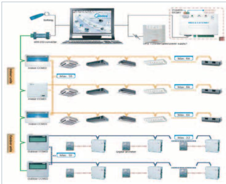
Se puede conectar una máximo de 4 grupos, cada uno de ellos con una máximo de 64 interiores y 32 exteriores. No necesita software.
