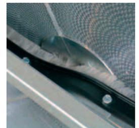
Junta de estanqueidad incorporada alrededor de todo el perímetro del rotor
