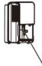
Fig.7 La manguera de la bomba gotea.
