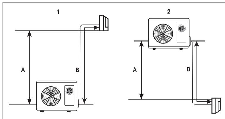
\* En el caso 2 (ud. exterior más alta) para desniveles superiores a 5~7 m es necesario instalar una trampa de aceite en la tubería de gas.
