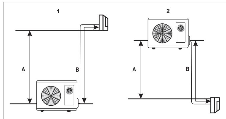
\* Dans le cas 2 (unité extérieure plus haute) pour dénivellations supérieures à 5~7 m il faut installer une trace d'huile au tuyau de gaz.
