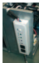
Detección de averías por LEDS
