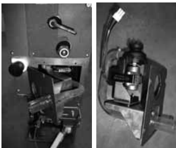
Bomba de condensados
