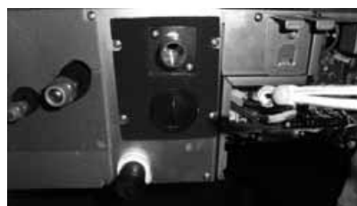
Toma de llenado para tests bomba
