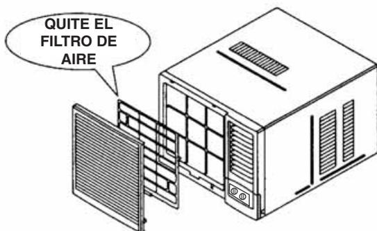
1. **Cambio de filtro de aire:** vea INSTALACIÓN, paso 1 pg 14
