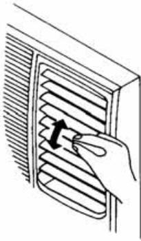
Ajuste del flujo vertical manual: Para ajustar la dirección del flujo de aire vertical, hágalo mediante cualquiera de los deflectores. Cuando las mueva hacia arriba o hacia abajo, mantenga siempre en posición horizontal los deflectores superiores e inferiores. Esto puede ayudarle a prevenir la condensación de las gotas de agua en el panel frontal de la unidad.
