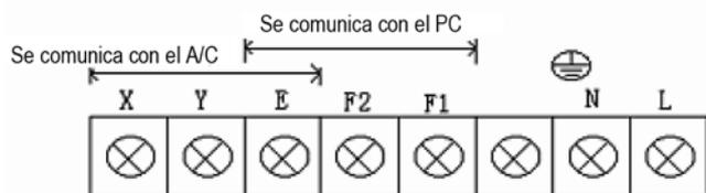
• **F1, F2, E:** El F1, F2 y E de todos los CCM están conectados juntos en Bus hasta el final del RS485 del interfaz de conversión RS232/RS485
