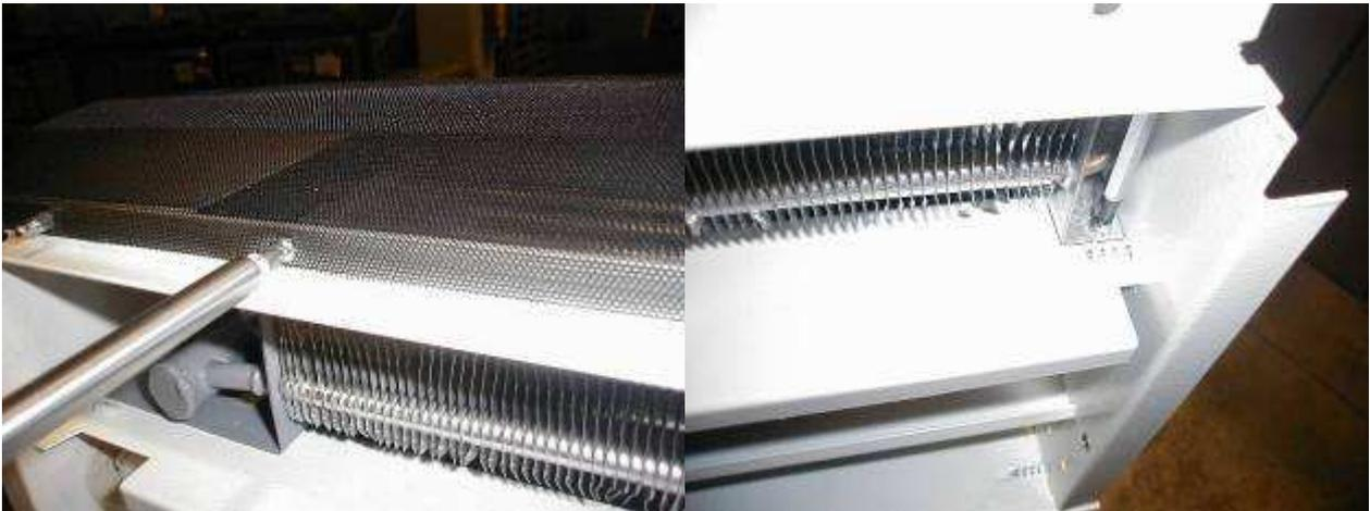
Una vez quitados los tornillos procedemos a sacar la batería utilizando guantes para evitar cualquier corte.
