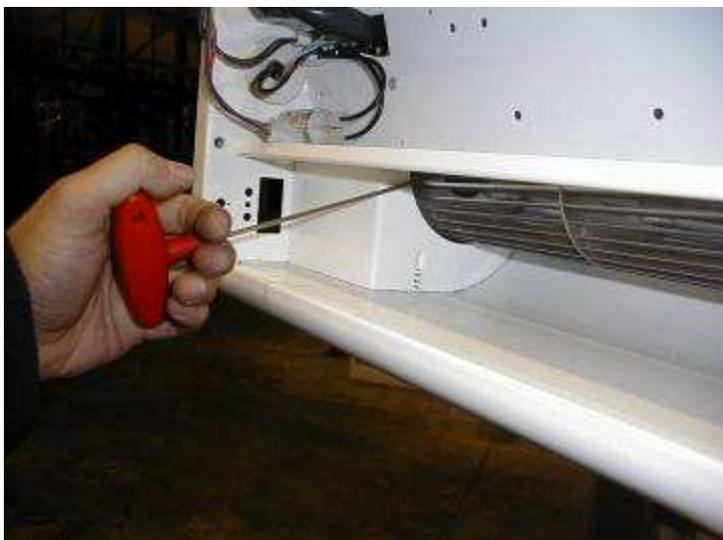
Retire el motor soltando los tornillos de fijación. Monte el de recambio siguiendo el proceso en orden inverso, asegurándose que el motor y la turbina encajan perfectamente, el tornillo de la turbina debe coincidir con la parte plana del eje del motor.
