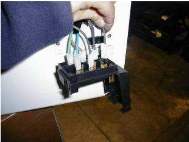
Desconecte los cables 2, 3, 4 de la caja conexiones.
