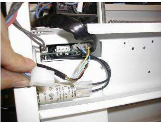
**Cambio de la placa de potencia:** abra la puerta de revisión y desconecte los cables de la placa que sean visibles y el condensador.
