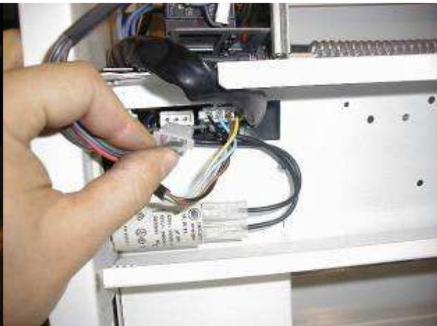
Desconecte los dos conectores de la placa de potencia.
