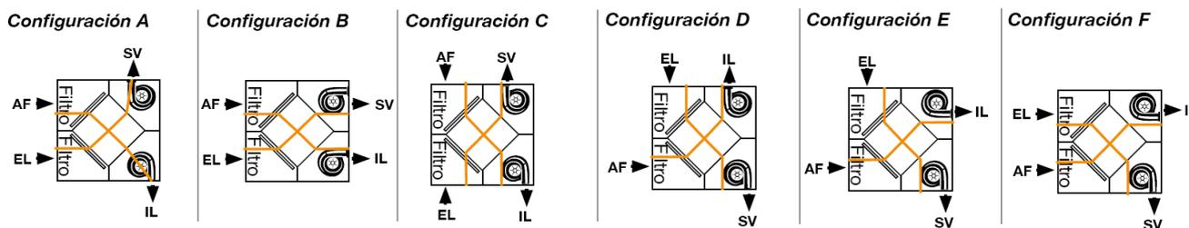
AF: Aire fresco exterior / IL: Impulsión aire al local / SV: Salida aire viciado / EL: Extracción aire del local
