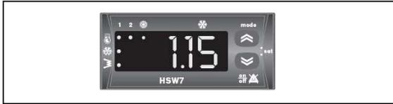
– La temperatura del agua de retorno de la instalación se mostrará en la pantalla.
