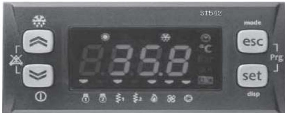
El panel frontal de la unidad viene montado de serie de fábrica y es la interfaz del usuario para gestionar las funciones de la unidad.
