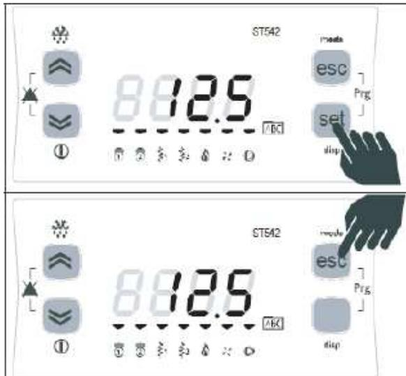
Una vez alcanzado el valor requerido presione la tecla “SET” el dispositivo almacenará el valor 12.5°C.
