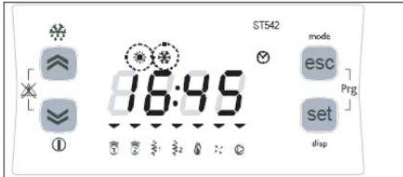
Automáticamente volverá a la pantalla principal. Podrá comprobar que el LED de modo de espera se desactiva y que se enciende el del modo de funcionamiento seleccionado.
