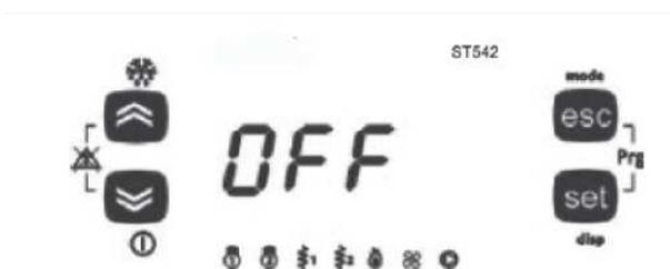
Se mostrará “OFF” en la pantalla. Todos los demás LEDs se apagarán.
