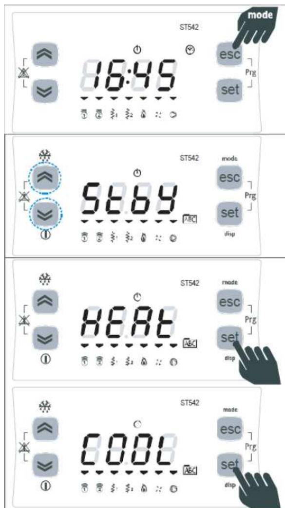
Por ejemplo, si quisiera cambiar del modo en espera al modo refrigeración, presione y mantenga pulsado el botón "modo" un mínimo de 2 segundos.
