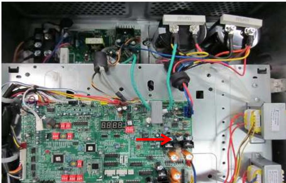
La dirección de la corriente en el cable de alimentación de CC que discurre a través del inductor debería ser la misma que la dirección de la flecha que aparece en el inductor.
