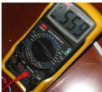
Paso 2: compruebe la tensión del condensador. El valor normal debe ser de 510 V ±30 V o 310 V ±30 V. Si no está en estos rangos es que el circuito impreso falla y hay que sustituirlo.
