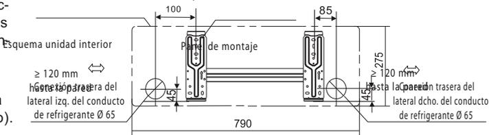
Correcta orientación del panel de montaje
