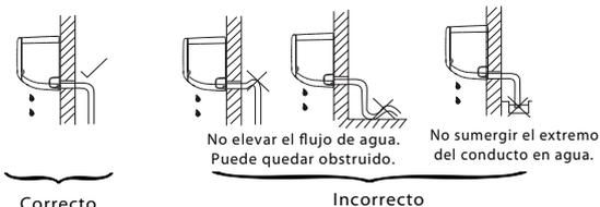
Conductos de conexión
