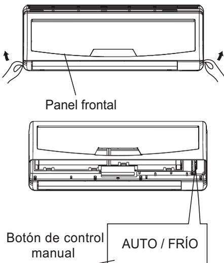
**NOTA:** La unidad debe ser desconectada antes del funcionamiento manual. Si la unidad continúa en funcionamiento manual, pulse el botón de control manual hasta que quede desconectada.
