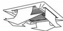
Cuando use el panel con las lamas automáticas, pulse la tecla SWING. Las lamas se balancearán automáticamente y conseguirá un mejor efecto de refrigeración o calefacción.
