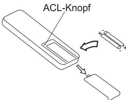
1. Schieben Sie die Batteriefach-Abdeckung in der durch den Pfeil angegebenen Richtung heraus und nehmen Sie sie ab.
